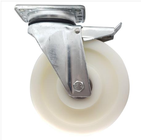
PEVOLON® es un material termoplástico a base de poliamida que no deja marcas, tiene buena resistencia química, alta resistencia a la abrasión, baja resistencia a la rodadura y una alta capacidad de carga de hasta 2 toneladas. El material también tiene una alta resistencia al frío y al calor (-40 ° C a + 90 ° C). PEVOLON® es adecuado para su uso en áreas que incluyen cámaras de refrigeración, cuartos húmedos y cuartos de cocina, así como ahumaderos.
