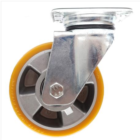
PEVOPUR® es un poliuretano de alta calidad que ofrece buena capacidad de carga dinámica, alta elasticidad, y buena resistencia al desgaste mecánico. PEVOPUR® también es significativamente más resistente que el caucho. Es un material particularmente adecuado para aplicaciones de uso medio-pesado y es ideal para su uso en climas tropicales.
