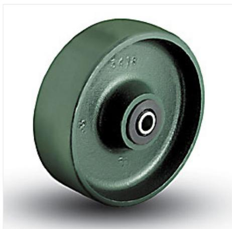
Esta rueda es para un servicio excepcionalmente pesado donde la protección del piso no es un factor relevante. Las ruedas de acero forjado tienen una construcción casi irrompible, una gran resistencia al desgaste y reciben impactos muy bien en el servicio de tracción. No deben usarse si el ruido es motivo de gran preocupación o si las cargas son frágiles.
