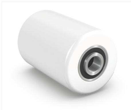
PEVOLON® es un material termoplástico a base de poliamida que no deja marcas, tiene buena resistencia química, alta resistencia a la abrasión, baja resistencia a la rodadura y una alta capacidad de carga de hasta 2 toneladas. El material también tiene una alta resistencia al frío y al calor (-40 ° C a + 90 ° C). PEVOLON® es adecuado para su uso en áreas que incluyen cámaras de refrigeración, cuartos húmedos y cuartos de cocina, así como ahumaderos.
